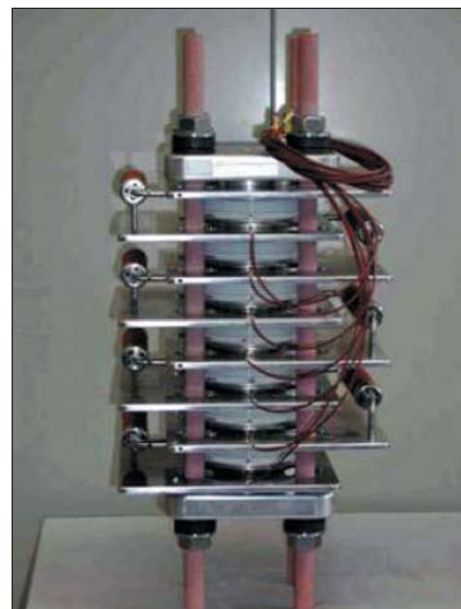
Рис. 12. Пример механической конструкции высоковольтной силовой биполярной сборки (30 кВ, 40 кА, длительность рабочего импульса 10 мс) на основе высоковольтных силовых оптотиристоров для преобразователя импульсной мощности
