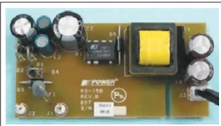
Рис. 4. Макет собранного источника питания 5 В, 1000 мА
