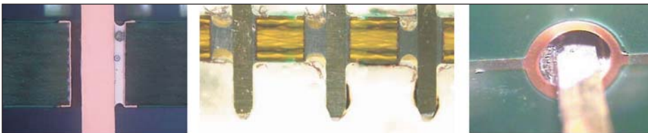
Рис. 2. Возможный результат пайки выводных компонентов с применением технологии Pin-in-Paste
