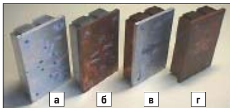
Рис. 2. Испытываемые охладители: а) алюминиевый — АlВ-АlF; б) с медным основанием/алюминиевыми ребрами — СuВ-АlF; в) алюминиевым основанием/медными ребрами — АlВ-СuF; г) медный — СuВ-СuF
