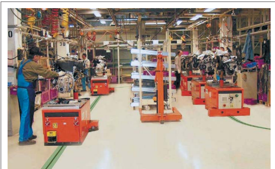
Рис. 12. CPS на автосборочном производстве. Первичная линия проложена в полу вдоль пути следования и защищена
