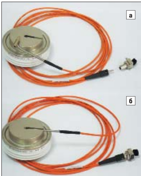
Рис. 1. а) Фототиристор типа ТФ 353-630 с оптическим окном в катодном основании; б) пример подключения ЛТТ-адаптера к фототиристор и лазерному диоду
