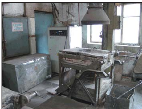
Рис. 20. Состав индукционного комплекса для порционной плавки металлов
