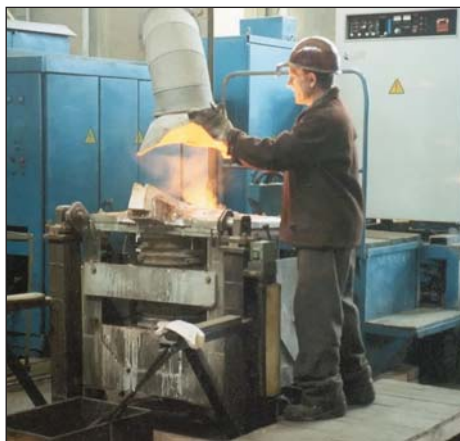
Рис. 21. Контроль плавки в индукционной печи
