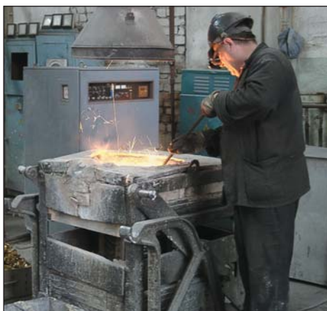
Рис. 22. Плавка в графитовом тигле раздаточной индукционной электропечи
