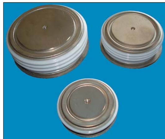
Рис. 1. Силовые кремниевые резисторы таблеточной конструкции
