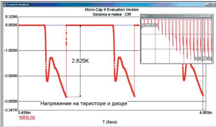
Рис. 6. Участок временной диаграммы на вентильной паре тиристор – диод
