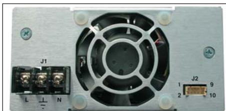
Рис. 7. Правильно установленная защитная крышка вентилятора уменьшает шум вентилятора
