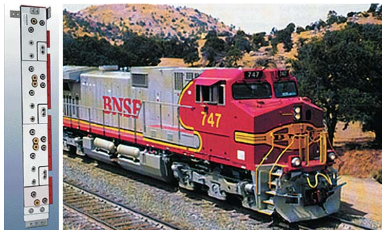
Рис. 3. Пример ламинированной силовой шины, используемой в электротранспорте
