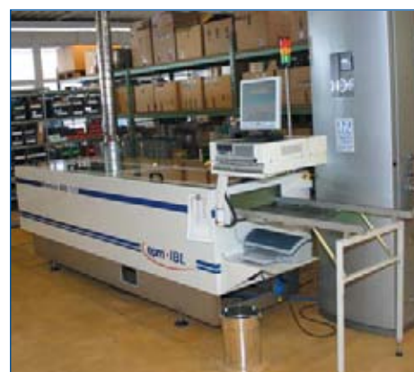
Рис. 4. Установка для пайки волной припоя типа Premium 400 TMS производства EPM
