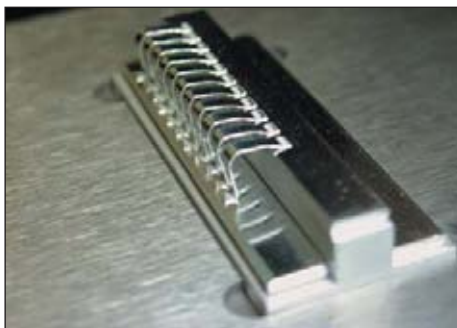
Рис. 4. Возможность получения сверхплоских петель с большим перепадом высот контактных площадок
