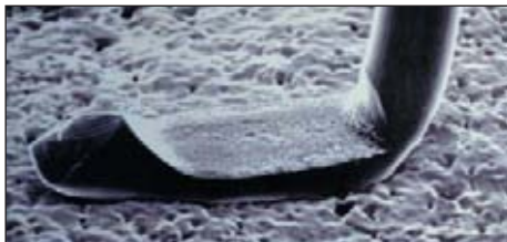
Рис. 9. Овальная форма пятна контакта при сварке проволокой
