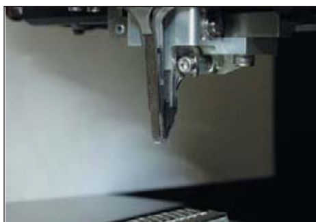
Рис. 8. Рабочий инструмент для сварки лентой: нож, инструмент, пластиковая направляющая (F&K Delvotec G5)
