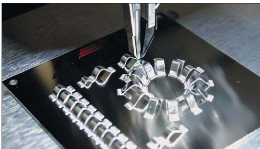
Рис. 1. Стандартная разварка силового модуля толстой алюминиевой проволокой
