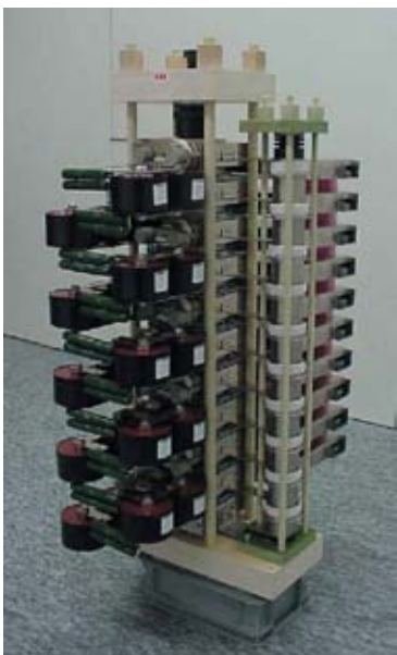
Рис. 7. Симметричный ключ с УЗО / МОВ 5SHV 35L45-10-CC
