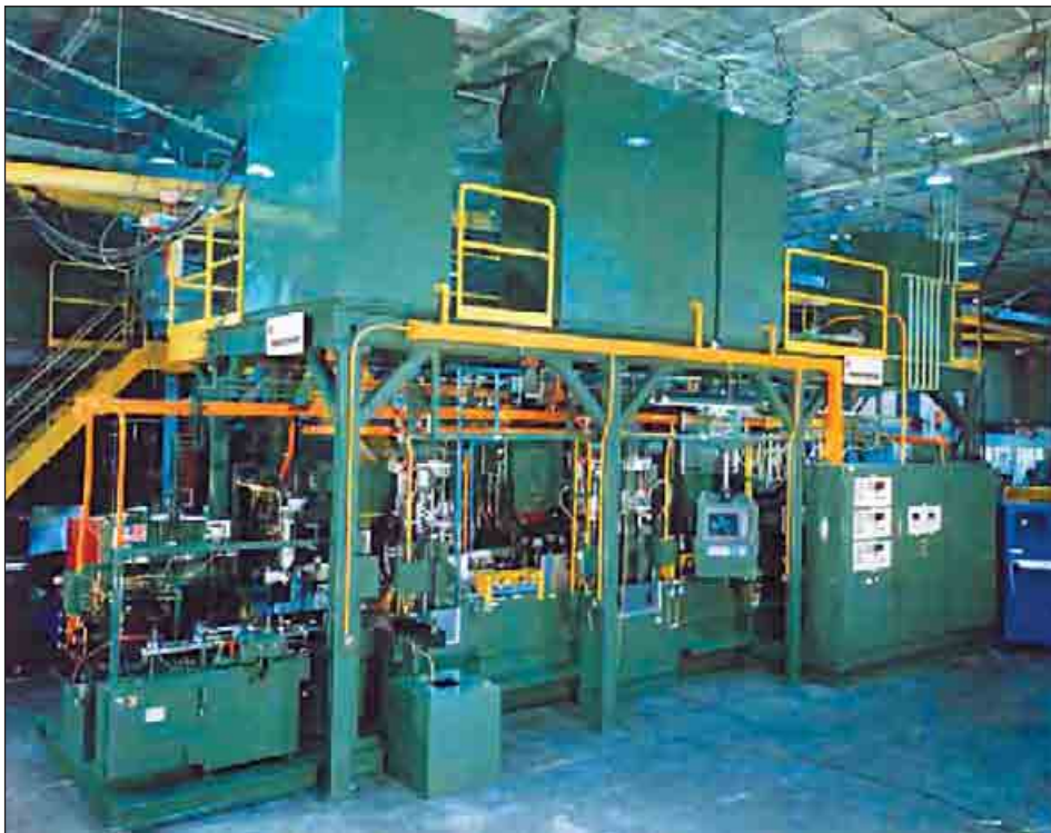
Рис. 12. Установка Inductoheat для закалки стыка колеса, обеспечивающая постоянную скорость вращения
