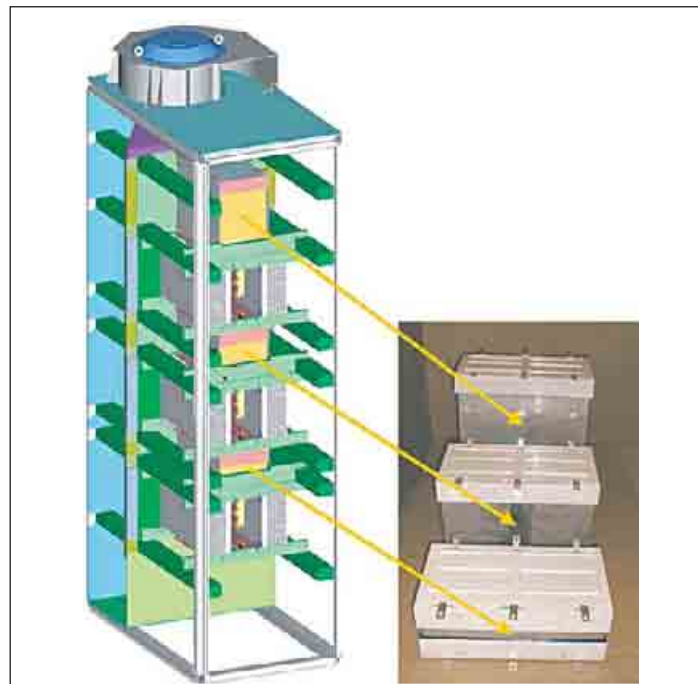
Рис. 5. Многоуровневый привод ALSTOM Symphony: низкоиндуктивное исполнение внутри ячейки. Аксиальные конденсаторы звена постоянного тока [7]
