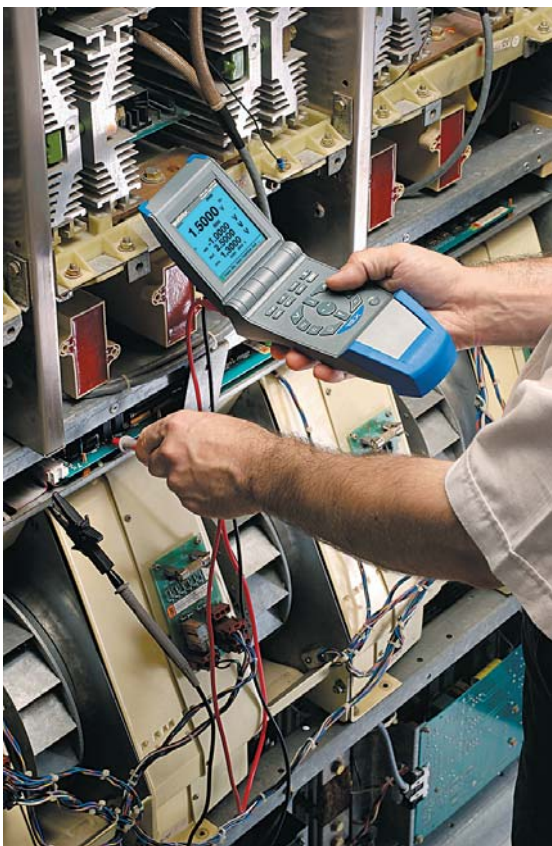
Рис. 5. Мультиметр MTX 3280 — управление выполняется рукой, которая держит прибор
