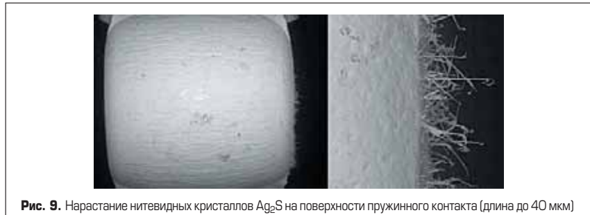
Рис. 9. Нарастание нитевидных кристаллов Ag 2 S на поверхности пружинного контакта (длина до 40 мкм)
