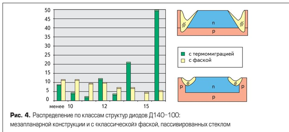
Рис. 4. Распределение по классам структур диодов Д140-100: мезапланарной конструкции и с «классической» фаской, пассивированных стеклом
