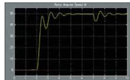
Рис. 37. Результаты совместного моделирования Simulink-PSpice схемы управления скоростью двигателя постоянного тока с контроллером на основе ОУ с обратной связью по постоянному току ( R_4 = 10 \text{ МОм} )
