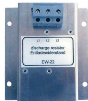
Рис. 6. Резистор EW-22 производства EPCOS AG для разряда КБ, управляемых тиристорными контакторами, установленный на монтажной панели
