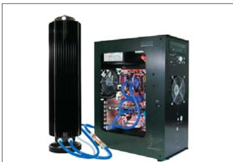
Рис. 4. Жидкостная система охлаждения фирмы Zalman, установленная на серийном компьютере
