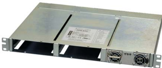
Рис. 7. Внешний вид 19-дюймового каркаса FPSS1U с установленным блоком питания FPS1000-48. Отсутствие вентиляционных отверстий в крышке и дне конструкции дополнительно обеспечивает надежное функционирование модулей в промышленных условиях эксплуатации
