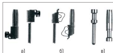
Рис. 5. Силовые контакты промышленных разъемов: а) соединение с проводом с помощью винта; б) соединение с проводом с помощью пружины; в) соединение с проводом с помощью обжима
