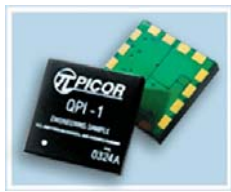
Рис. 5. Модуль фильтра QPI-1 Picor (размеры 25×25×5 мм)
