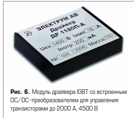
Рис. 5. Драйвер IGBT со встроенным DC/DC-преобразователем для управления транзисторами до 2000 А, 4500 В
