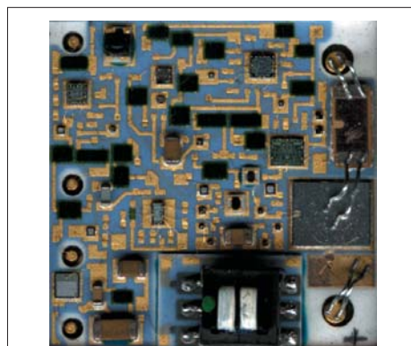
Рис. 4. Сборка интеллектуального контроллера цепей питания и нагрузок
