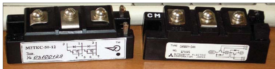
Рис. 7. Силовые модули КСМТ серии M2TKC-50-12 и IGBT серии CM50DY-24H
