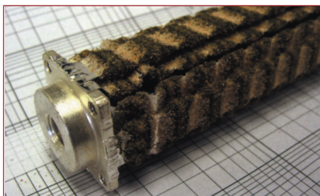
Рис. 4. Вид перемычки предохранителя после воздействия тока короткого замыкания 100 кА
