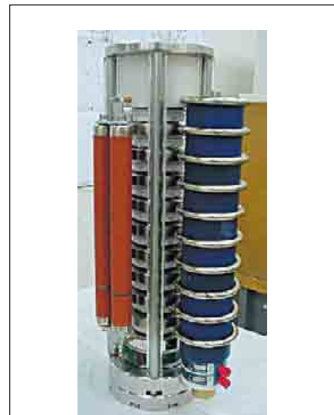
Рис. 7. Высоковольтный коммутатор, выполненный по заказу для CERN
